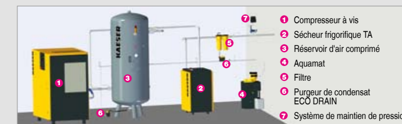
Station d'air comprimé avec composants individuels
