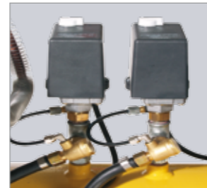
Deux pressostats Démarrage à vide des compresseurs sans contre-pression; pressions d'enclenchement et d'arrêt réglables individuellement.
