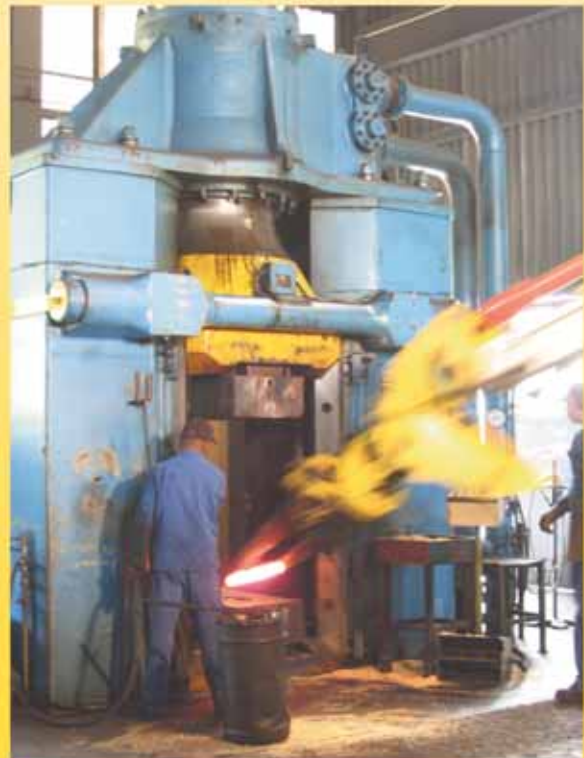
Schmiedehammer im Einsatz
